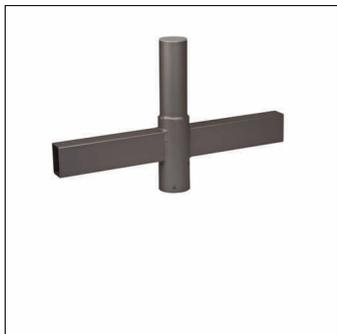
SiCOMPACT® A2 MIDI, console multiple, console pour mât, en acier galvanisé, laqué, fer micacé Siteco® (DB 702S), 2 bras, pour 2 projecteurs, diamètre: 76mm, embout : 76mm (sur le mât), unité d'emballage: 1 pièce
