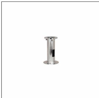
accessoires, boîtier, pour CL BORNE D'ECLAIRAGE 60, CL BORNE D'ECLAIRAGE 30, boîtier enterré, cylindrique, en acier, galvanisé, longueur: 250 mm, unité d'emballage: 1 pièce
