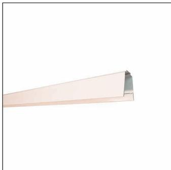
Licross®, canale di montaggio, in lamiera di acciaio, zincata, verniciatura in bobina, bianco, lunghezza: 2.250 mm, larghezza: 64 mm, altezza: 67mm, grado di protezione (totale): massimo IP64, a seconda dei listelli e degli accessori utilizzati, classe di isolamento (totale): classe isolamento I (messa a terra), marchi di qualità: CE, UKCA, conformità LABS testata secondo VDMA 24364:2018-05, unità d'imballo: 1 pezzo
