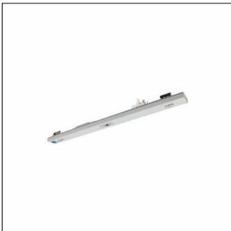
Modario® 31 Sensormodulo sensore PR3-S, master, controllo locale, dimmerabile, luogo di montaggio: sul canale portante Modario®, in lamiera di acciaio, grado di protezione (totale): IP20, classe di isolamento (totale): classe isolamento I (messa a terra), marchi di qualità: CE, VDE, tensione: 230V, tipo tensione: AC, 1 x ingresso tasti, 1 x sensore ottico, 1 x DALI, unità d'imballo: 1 pezzo
