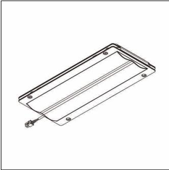
Streetlight 10 mini/midi, LED-Modulo, conduzione primaria della luce con sovrappassi pedonali, asimmetrico con diffusione a sinistra, distribuzione luminosa: PC-L, High Power LED, colore della luce: 740, temperatura di colore: 4000K, allacciamento alla rete: 230..240V, 50Hz, LED-Modulo, lunghezza: 310mm, larghezza: 137mm, altezza: 40mm, grado di protezione (totale): come l'apparecchio, unità d'imballo: 1 pezzo
