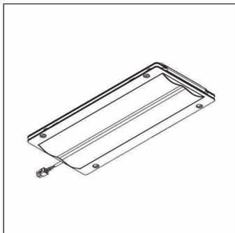
Streetlight 10 mini/midi, LED-Modulo, conduzione primaria della luce con ottica speculare per piste ciclabili, distribuzione luminosa: P1.0a, distribuzione luminosa primaria: asimmetrica, High Power LED, colore della luce: 718, temperatura di colore: 1800K, allacciamento alla rete: 230..240V, 50Hz, LED-Modulo, lunghezza: 310mm, larghezza: 137mm, altezza: 40mm, grado di protezione (totale): come l'apparecchio, unità d'imballo: 1 pezzo
