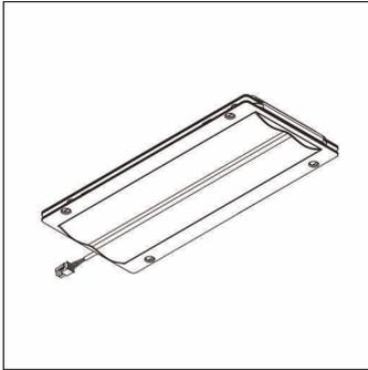
Streetlight 10 mini/midi, LED-Modulo, distribuzione luminosa: ST1.2P1.0, High Power LED, colore della luce: 750, temperatura di colore: 5000K, allacciamento alla rete: 230..240V, 50Hz, LED-Modulo, lunghezza: 310mm, larghezza: 137mm, altezza: 40mm, grado di protezione (totale): come l'apparecchio, unità d'imballo: 1 pezzo
