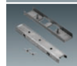
Verbinder für Module | Stahlblech, verzinkt | durch Verschraubung selbsttragende Verbindung der Leuchten-Module | (mind. 1 Abhängung im Bereich bis max. 1,5m neben der Stoßstelle erforderlich)
