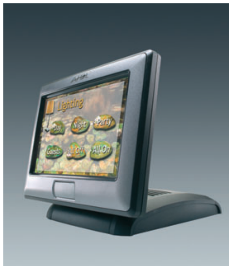
Touch-Panel 7" Tischaufbau und Wandeinbau mit integriertem Mikrofon | Lautsprecher | Näherungs- und Lichtsensor | 6 frei belegbare Funktionstasten
