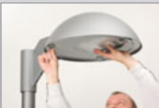
1. Leuchte öffnen: Zwei Drehriegel sichern die Leuchtenabdeckung.
