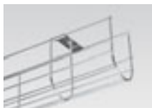
Drahtschutzkorb Stahldraht, Ø = 4mm, verzinkt inkl. Montagebügel
