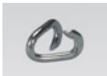
Notglied verzinkt Gliedermaß Innen 8 x 20mm Tragkraft: 50kg
