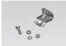
Universal-Leuchtenabhänger für Spanndraht ( \varnothing \leq 4,5\text{mm} ) oder Kette ( \varnothing_{\text{Innen}} \geq 7\text{mm} ) Tragkraft: 25kg
