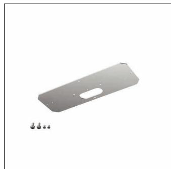
Licross Modulplatte rechteckig Adapterplatte aus Aluminium, unbeschichtet, Abmessung: (LxBxH) = 200 x 70 x 2mm; Prüfzeichen: CE, UKCA; Verpackungseinheit: 1 Stück
