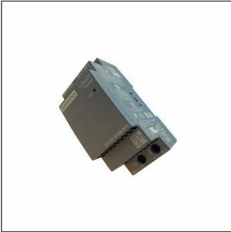
SITECO Connect Group, Stromversorgung, Montageart: DIN-Schienen-Montage, Netzanschluss: 230V, AC, Gehäuse, aus Kunststoff, grau, 2 Teileinheiten, Länge: 53mm, Breite: 36mm, Höhe: 90mm, Netzteil, Verteilungseinbau, Schutzart (gesamt): IP20, Schutzklasse (gesamt): SK II (Schutzisoliert), Prüfzeichen: CE, zul. Betriebsumgebungstemperatur für Außenanwendungen: -20..+70°C, zul. Lagertemperatur: -20..+85°C, Verpackungseinheit: 1 Stück
