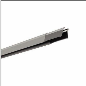
Licross®, Tragschiene, aus Stahlblech, verzinkt, bandlackiert, weißaluminium (RAL 9006), Länge: 1.500 mm, Breite: 64 mm, Höhe: 67mm, Schutzart (gesamt): maximal IP64, abhängig von den verwendeten Einsätzen und Zubehören, Schutzklasse (gesamt): SK I (Schutzerdung), Prüfzeichen: CE, UKCA, LABS-Konformität geprüft gemäß VDMA 24364:2018-05, Verpackungseinheit: 1 Stück
