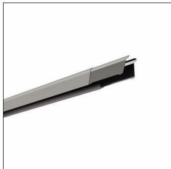
Licross, Tragschiene, aus Stahlblech, verzinkt, bandlackiert, weißaluminium (RAL 9006), Länge: 1.500 mm, Breite: 64 mm, Höhe: 67mm, Durchverdrahtung: 14x 2,5mm<sup>2</sup>, Schutzart (gesamt): maximal IP64, abhängig von den verwendeten Einsätzen und Zubehören, Schutzklasse (gesamt): SK I (Schutzerdung), Prüfzeichen: CE, UKCA, LABS-Konformität geprüft gemäß VDMA 24364:2018-05, Verpackungseinheit: 1 Stück
