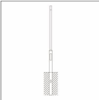
Mast, Mast, zylindrisch abgesetzt, aus Stahl, pulverbeschichtet, Siteco® eisenglimmer (DB 702S), Höhe: 3m, Zopfmaß: 76mm (Aufsatz), Erdstück: h= 600mm / Ø= 114mm, Norm: DIN EN 40, Verpackungseinheit: 1 Stück
