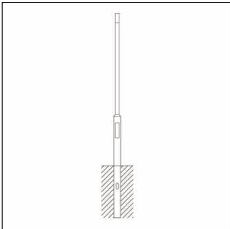
Mast, Mast, zylindrisch abgesetzt, aus Stahl, verzinkt, Höhe: 6,0m, Zopfmaß: 76mm (Aufsatz), Erdstück: h= 1000mm / Ø= 114mm, Norm: DIN EN 40, Verpackungseinheit: 1 Stück
