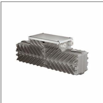
Sirius®, EVG-Einheit, 3/4polig (3/4G), max. 2,5mm<sup>2</sup> + 2xRJ45 (DMX In/Out), Vorschaltgerät: DMX, mit Klemme, Netzanschluss: 220..240V/380..415V, AC, 50/60Hz, mit Systemverbinder oder Klemme, EVG-Einheit, aus Aluminium-Druckguss, pulverbeschichtet, Siteco® eisenglimmer (DB 702S), Länge: 635mm, Breite: 181mm, Höhe: 247mm, Schutzart (gesamt): IP66, Schutzklasse (gesamt): SK I (Schutzerdung), Prüfzeichen: CE, ENEC, Verpackungseinheit: 1 Stück
