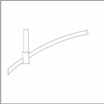
Bern, Mastausleger, Designausleger, aus Stahl, verzinkt und lackiert, Siteco® eisenglimmer (DB 702S), 1armig, Zopfmaß: 76mm (Aufsatz), Auslegermaß: 1.500mm, Verpackungseinheit: 1 Stück
