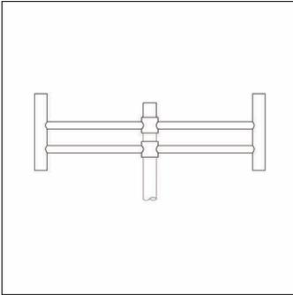
Schiene, Mastausleger, Designausleger, aus Stahl, verzinkt und lackiert, Siteco® eisenglimmer (DB 702S), 2armig, mit integriertem Mastabschluss, Zopfmaß: 76mm (Aufsatz), Auslegermaß: 600mm, Verpackungseinheit: 1 Stück
