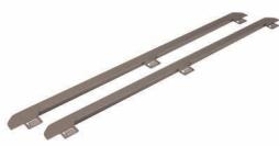
Streetlight SL 11 mini/midi; Blende für seitliche Abschirmung, (Blendbegrenzungsklasse G4), aus Stahlblech, SITECO eisenglimmer (DB 702S); Höhe: 16mm; Verpackungseinheit: 1 Satz = 2 Stück
