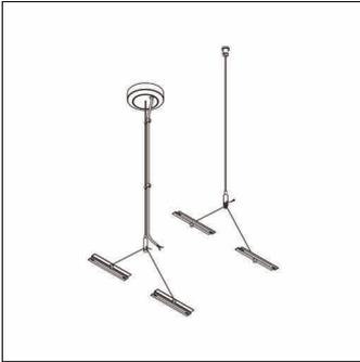
Apollon®, Y-Seilabhängung, Deckenhülse, Deckenbefestigungselement, aus Stahl, verzinkt, Baldachin, rund, aus Kunststoff, Seil, aus Stahl, verzinkt, leuchtenseitige Befestigung, aus Stahl, verzinkt, Deckenhülse, aus Stahl, vernickelt, Verpackungseinheit: 1 Satz = 2 Stück
