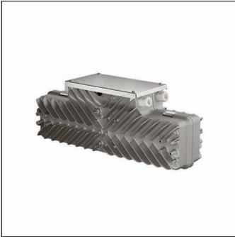
Sirius®, EVG-Einheit, 3/4polig (3/4G) + 1polig (LST) / 2polig (DALI), max. 2,5mm<sup>2</sup>, Vorschaltgerät: EVG, mit Klemme, Netzanschluss: 220..240V/380..415V, AC, 50/60Hz, mit Systemverbinder oder Klemme, EVG-Einheit, aus Aluminium-Druckguss, pulverbeschichtet, Siteco® eisenglimmer (DB 702S), Länge: 635mm, Breite: 181mm, Höhe: 247mm, Schutzart (gesamt): IP66, Schutzklasse (gesamt): SK I (Schutzerdung), Prüfzeichen: CE, ENEC, Verpackungseinheit: 1 Stück
