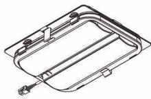
Streetlight 10 micro, LED-Modul, primäre Lichtlenkung mit Radweg-Optik, Lichtverteilung: P1.0a, primäre Lichtcharakteristik: asymmetrisch, High Power LED, Lichtfarbe: 718, Farbtemperatur: 1800K, Netzanschluss: 230..240V, 50Hz, LED-Modul, Länge: 174mm, Breite: 137mm, Höhe: 40mm, Schutzart (gesamt): wie Leuchte, Verpackungseinheit: 1 Stück
