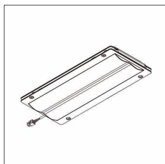
Streetlight 10 mini/midi, LED-Modul, primäre Lichtlenkung mit Fußgängerüberweg, asymmetrisch rechts strahlend, Lichtverteilung: PC-R, High Power LED, Lichtfarbe: 722, Farbtemperatur: 2200K, Netzanschluss: 230..240V, 50Hz, LED-Modul, Länge: 310mm, Breite: 137mm, Höhe: 40mm, Schutzart (gesamt): wie Leuchte, Verpackungseinheit: 1 Stück
