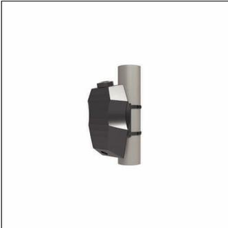
SITECO Connect Wireless Mast Box Motion GPS High, Montageart: Anbau, Montageort: am Mast, aus Kunststoff, Spannung: 230V, Spannungsart: AC, 2,4GHz, Lokales Maschen-Funknetzwerk, DALI, Lokale Einstellung und - Bedienung mit USB-Stick, nach Bewegung, optional per Funk-Taster, nach Uhrzeit, nach Timer, nach Wochentag, mit Funkuhr, GPS, 1 PIR Bewegungssensor, GPS, Funk, 2,4GHz, Schutzart (gesamt): IP65, Prüfzeichen: CE, Verpackungseinheit: 1 Stück
