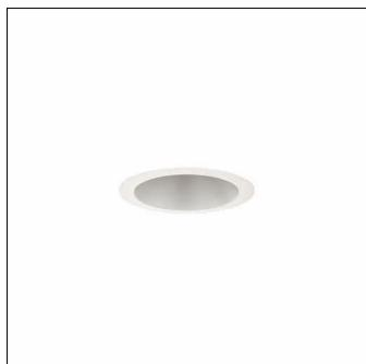
Lunis 31-L, Downlight, Lichtlenkung mit Reflektor, Lichtaustritt: direkt strahlend, LED Bemessungslichtstrom: 1.650lm, Lichtfarbe: 840, Netzanschluss: 220..240V, AC/DC, 0/50..60Hz, Gehäuse, aus Aluminium, weiß, Schutzart (gesamt): IP20, Schutzart (raumseitig): IP54, Schutzklasse (gesamt): SK II (Schutzisoliert), Prüfzeichen: CE, ENEC, Verpackungseinheit: 1 Stück
