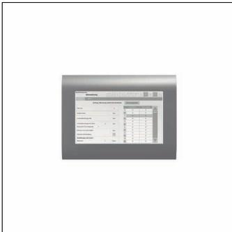
SITECO Connect 11 Grundpaket M/P, 1..18 DALI-Linien, 7" Touch-Panel-PC mit Intel Atom®, max. 4 Cores, 7" TFT-Display, zentrale Steuerung, Montageart: Einbau, Montageort: in einer elektr. Verteilung, Schutzart (gesamt): IP20, Schutzklasse (gesamt): SK I (Schutzerdung), Prüfzeichen: CE, Spannung: 230V, Spannungsart: AC, 1 x DALI-2, Software: Lighting Solution, Verpackungseinheit: 1 Stück
