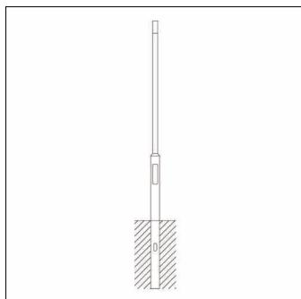
Mast, Mast, zylindrisch abgesetzt, aus Stahl, pulverbeschichtet, SITECO eisenglimmer (DB 702S), Höhe: 4,5m, Zopfmaß: 76mm (Aufsatz), Erdstück: h= 800mm / Ø= 114mm, Norm: DIN EN 40, Verpackungseinheit: 1 Stück
