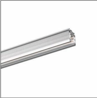
AX T, 3-Phasen Stromschiene, Montageart: abgehängte Montage, Anbau, Vorschaltgerät: EIN/AUS, Netzanschluss: 220..240V/380..400V, AC, aus Alu-Strangpreßprofil, lackiert, grau, Länge: 1.000mm, Breite: 32mm, Höhe: 33mm, Schutzart (gesamt): IP20, Schutzklasse (gesamt): SK I (Schutzerdung), Prüfzeichen: CE, ENEC, Verpackungseinheit: 1 Stück
