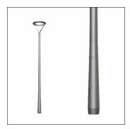
Mast, Mast, konisch rund, aus Aluminium, lackiert, Siteco® eisenglimmer (DB 702S), Höhe: 4,0m, Zopfmaß: 76mm (Aufsatz), Erdstück: h= 800mm / Ø= 160mm, Norm: DIN EN 40, Verpackungseinheit: 1 Stück
