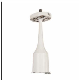
Baugruppe Elektrik, für Modul 540 iQ, Geräte-Träger, Vorschaltgerät: EVG iQ, LED Lichtstrom: 4.070 lm, Farbtemperatur: 2200K, mit Klemme, 6polig, max. 2,5mm<sup>2</sup>, Netzanschluss: 230..240V, AC, 50/60Hz, Beginn der Lebensdauer: 34 W, Ende der Lebensdauer: 36 W, Reduzierung: 15 W, primäre Lichtcharakteristik: stark asymmetrisch, Breite: 190 mm, Höhe: 514mm, Schutzklasse (gesamt): SK II (Schutzisoliert), Prüfzeichen: CE, ENEC, VDE
