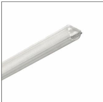
accessoires d'éclairage, pour Monsun®, vasque, en PMMA, structure prismatique, à l'intérieur, pour 1 x T16 | T26 35/49/58/80W, longueur: 1.571 mm, largeur: 84 mm
