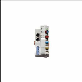
SITECO Connect 11 coupleur K-Bus, contrôle centrale - connexion à l'éclairage ou à la gestion du bâtiment, type de pose: encastré, emplacement de pose: dans un répartiteur électrique, degré de protection (total): IP20, marquage: CE, tension: 24V, type de tension: CC, 1 x K-Bus, unité d'emballage: 1 pièce
