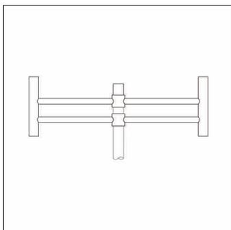
rail, console pour mât, console design, en acier, galvanisé et laqué, fer micacé Siteco® (DB 702S), 2 bras, avec une extrémité de mât intégrée, embout : 76mm (au sommet du mât), dimensions de la console: 600mm, unité d'emballage: 1 pièce
