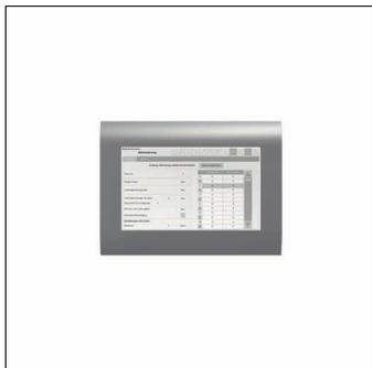
SITECO Connect 11 panneau d'extension, PC Touch Panel 7" avec ARM Cortex-A8, écran TFT 7", contrôle central, type de pose: encastré, emplacement de pose: dans une armoire de distribution, degré de protection (total): IP20, classe de protection (total): classe de protection I (mise à la terre), marquage: CE, tension: 24V, type de tension: CC, 1 x connexion réseau Ethernet, 2 x USB, 1 x interface série COM1, 1 x Ethernet, logiciel: Microsoft Windows Embedded Compact 7, unité d'emballage: 1 pièce
