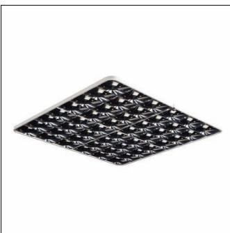
réflecteur de système de réflexion secondaire, pour SITECO Mirrortec Indoor, support de suspension par câble, boîtier, carré, en aluminium, laqué, aluminium blanc (RAL 9006), réflecteur 100 en technique de Fresnel, en PMMA, métallisé en aluminium, haute brillance, dispersion du point lumineux, structure en technique de Fresnel, longueur: 600 mm, largeur: 600 mm
