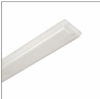
accessoires d'éclairage, pour Monsun®, vasque, en PMMA, structure prismatique, à l'intérieur, pour 2 x T16 | T26 14/18/24W, longueur: 661 mm, largeur: 130 mm
