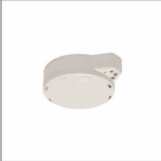
DALI2capteur D1, esclave, contrôle centrale - connexion à l'éclairage ou à la gestion du bâtiment, gradable, type de pose: en saillie, emplacement de pose: au plafond, en plastique, degré de protection (total): IP20, classe de protection (total): classe de protection I (mise à la terre), marquage: CE, UKCA, tension: 120..277V, type de tension: AC, 1 x capteur de luminosité, 1 x DALI-2, unité d'emballage: 1 pièce
