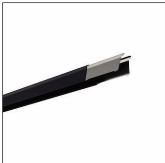
Licross®, rail, en tôle d'acier, galvanisé, laqué en bande, noir foncé mat (RAL 9005), longueur: 1.500 mm, largeur: 64 mm, hauteur: 67mm, câblage continu: 11x 2,5mm<sup>2</sup>, degré de protection (total): max. IP64, en fonction des éléments et accessoires utilisés, classe de protection (total): classe de protection I (mise à la terre), marquage: CE, UKCA, conformité LABS testée selon VDMA 24364:2018-05, unité d'emballage: 1 pièce
