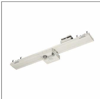
Licross®, Interface S, esclave, commande locale, contrôle central, gradable, emplacement de pose: sur le rail Licross®, en tôle d'acier, degré de protection (total): IP20, classe de protection (total): classe de protection I (mise à la terre), marquage: CE, ENEC, VDE, UKCA, 1 x DALI-2, unité d'emballage: 1 pièce
