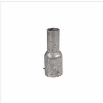
réducteur, type de pose: pose au sommet du mât, douille de réduction, en St 37-2, galvanisé, longueur: 230mm, diamètre: 42mm, embout : 60/42mm, unité d'emballage: 1 pièce
