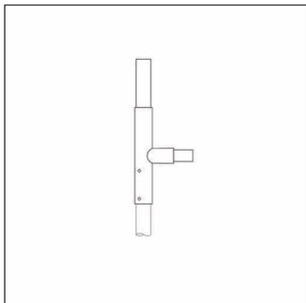
console pour mât, console, en acier, galvanisé et laqué, fer micacé Siteco® (DB 702S), 1 bras, désaxé, bras porteur court, embout : 76mm (au sommet du mât), dimensions de la console: 210mm, unité d'emballage: 1 pièce
