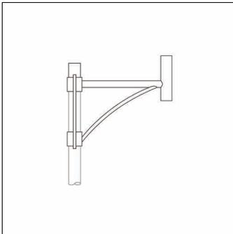
Arc, console pour mât, console design, en acier, galvanisé et laqué, fer micacé Siteco® (DB 702S), 1 bras, avec une extrémité de mât intégrée, embout : 76mm (au sommet du mât), dimensions de la console: 600mm, unité d'emballage: 1 pièce
