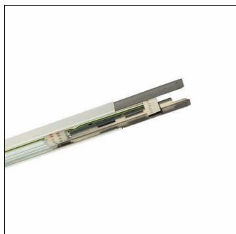
Modario, rail, en tôle d'acier, laqué, blanc brillant, à trois longueurs, longueur: 4.485 mm, largeur: 58 mm, hauteur: 43mm, câblage continu: 5x 2,5mm<sup>2</sup>, avec borne, 5 broches, 2,5mm<sup>2</sup> max., degré de protection (total): pour un degré de protection IP20/IP40, classe de protection (total): classe de protection I (mise à la terre), marquage: CE, ENEC, VDE, norme: EN 60598, unité d'emballage: 1 pièce
