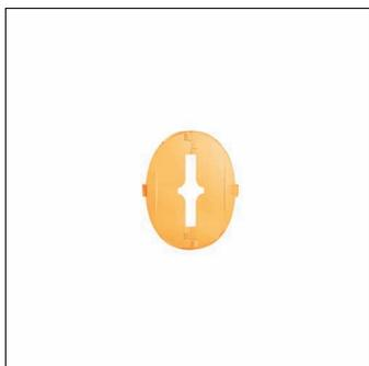
élément spreader, pour module 540, élément spreader, structuré, distribution extensive, orange, forte teinte, élément diffuseur orange, fortement teinté pour réduire la température de couleur de 4000K à env. 2200K ou de 3000K à env. 1900K, raccordement au secteur: 230..240V, unité d'emballage: 1 pièce
