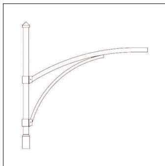
Innsbruck, console pour mât, console design, en acier, galvanisé et laqué, fer micacé SITECO (DB 702S), 1 bras, embout : 76mm (au sommet du mât), dimensions de la console: 1.200mm, unité d'emballage: 1 pièce
