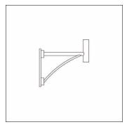
Arc, console murale, console design, en acier, galvanisé et laqué, fer micacé Siteco® (DB 702S), 1 bras, largeur: 100mm, hauteur: 500mm, dimensions de la console: 600mm, unité d'emballage: 1 pièce
