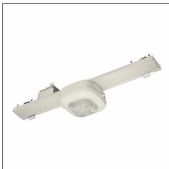
Licross® module de capteur PS2-S, esclave, contrôle centrale - connexion à l'éclairage ou à la gestion du bâtiment, gradable, emplacement de pose: sur le rail Licross®, en tôle d'acier, degré de protection (total): IP20, classe de protection (total): classe de protection I (mise à la terre), marquage: CE, UKCA, 1 x capteur de présence PIR, 1 x capteur de luminosité, 1 x DALI, unité d'emballage: 1 pièce
