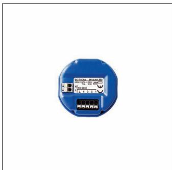
SITECO Connect Wireless bouton-poussoir, composant de gestion d'éclairage, esclave, contrôle local - technologie de capteur autonome, gradable, type de pose: encastré, emplacement de pose: dans le boîtier de raccordement, tension: 230V, 4 x entrée de bouton-poussoir, 1 x interface Bluetooth®, degré de protection (total): IP20, classe de protection (total): classe de protection II (double isolation), marquage: CE, unité d'emballage: 1 pièce
